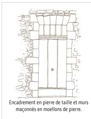
Façade en pierre de taille appareillée à jointée au mortier de chaux.
